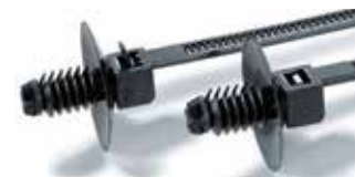
Matière Polyamide 6.6 (PA66) Températures d'utilisation -40 °C à +85 °C (+105 °C pendant 500 h) Tenue au feu Auto-extinguible UL94 V2
