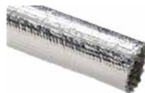
Matière Fibre de verre recouvert d'aluminium Températures d'utilisation -60 °C à +255 °C h) Tenue au feu Auto-extinguible UL94 V2
